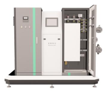
二次供水设备选用气压式供水。运用密封罐体,运用罐内高压气水压力抵达供水目的。具体作业次第是由水泵将水通过逆止阀压入罐体,使罐内气体遭到紧缩,压力逐渐增大。当压力抵达指定上限时电接点压力表通过控制柜使泵机自动接连。设备中的水压高于外界管网压力,自动送水至供水管网。当罐体内水位下降,变频恒压供水罐内气体膨涨压力减小到指定的下限方位时,电接点压力表通过控制柜使水泵重新启动。如此重复,使设备不断供水。当罐内气体缺少时,补气阀可自动补气。黑龙江双模箱式供水公司二次供水 无负压供水 变频供水制造厂商。
