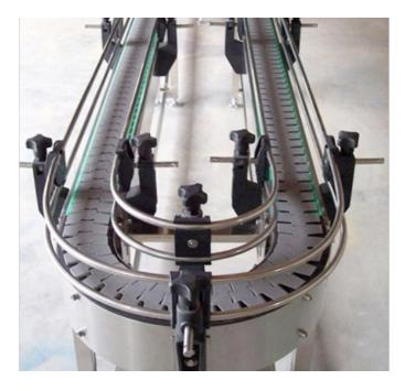
链板输送机的连接环损坏大致就是由于以下五个原因造成的,这要求企业在使用链板输送机时需要定期做好设备的检修工作,发现问题立即进行处理。在实际使用中,由于接链环往往比输送链条稍大,磨损情况比较严重,因此接链环成了整个传送链条中的薄弱点。它的损坏形式主要为严重磨损、断裂、拉开,其产生的原因主要为: 1、长期承受脉动载荷,疲劳破坏; 2、连接销或螺栓松动脱落,未能及时发现补充,致使接链环受力不均或拉托; 3、对于立环,单边磨损更为严重,如不及时更换,容易发生断裂; 4、卡链后,会产生很大的动载荷和冲击载荷,导致传送链条运动速度的瞬时巨大的波动,使传送链条运行不平稳,从而加速接链环磨损或断裂; 5、生产制造质量较差,耐磨性差或韧性差硬度低,或者出现应力集中产生疲劳裂纹,导致强度不足。
