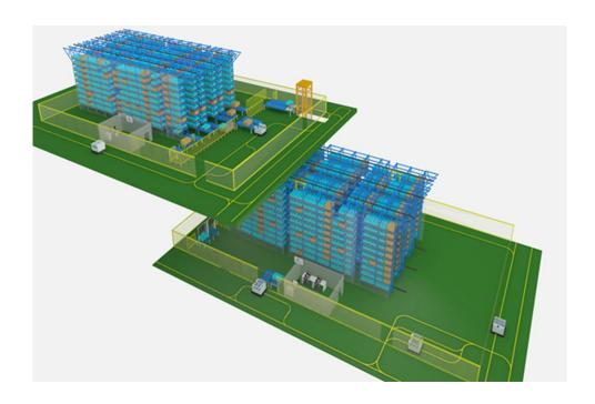
自动化立体仓库,是物流仓储中出现的新概念。利用立体仓库设备可实现仓库高层合理化、存取自动化、操作简便化;自动化立体仓库是当前技术水平较高的形式。自动化立体仓库的主体由货架、巷道式堆垛起重机、入(出)库工作台和自动运进(出)及操作控制系统组成。货架是钢结构或钢筋混凝土结构的建筑物或结构体,货架内是标准尺寸的货位空间,巷道堆垛起重机穿行于货架之间的巷道中,完成存、取货的工作。管理上采用计算机及条形码技术。
