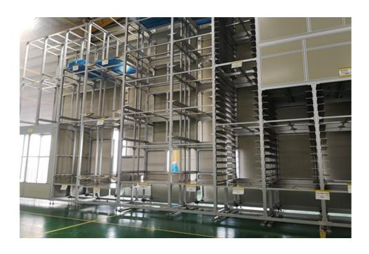
自动化立体仓库[AS/RS/ System]是可对集装单元货物实现自动化储取和计算管理的仓库,自动化立体仓库由几大系统组成,其中包含了主要的货架系统,还有: 堆垛机系统、仓库输送系统、托盘及物料、控制系统。
