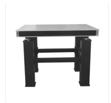
光学平台的磨削是有极限的,这个加工的极限一般是在±0.01mm/600mm×600mm左右,换算成平方米大约为□±0.03mm/m2□但这个平面度,同大理石平台的平面度相差甚远。大理石平台根据平面度指标一般分为: 000级(平面度≤3μm/m2□□00级(平面度≤5μm/m2□□0级(平面度≤10μm/m2□□换句话说,平面度合适的光学平台,同低等级的大理石平台相比,平面度还差数倍甚至一个数量级,所以若您需要高平面度的台面,强烈建议您选购大理石平台。
