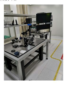
精密光学平台的桌腿中装有气动单元,它与平台的材料及设计相结合可以减少环境中的物体(例如人员走动、建筑物内其它设备以及行驶的汽车等)造成的大幅度低频振动。这些外部力会使平台发生刚体运动,这种运动本质上是2维的并且对大多数光学实验不会造成影响。在千赫兹频段的高频振动也不会明显地影响平台的稳定性。然而,造成精密光学平台表面弯曲的中频共振及弯曲振动会对光学实验的准直造成极大影响。优良的精密光学平台不仅需要高精度的机器设备来加工,更需要有高精度检测手段与检测仪器来保证,也只有优良的光学平台才能保证高精度的科学实验、研究的正常进行。安徽Newport光学平台光学平台平面度,对于隔振性能,没有任何影响。
