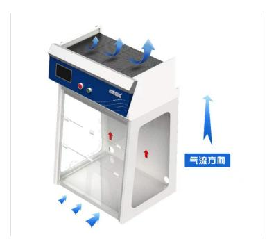
通风柜使用注意事项有哪些? 1、不要将物品(包括化学品)存放在通风柜中。它们不只会阻挡气流,还会干扰污染物控制。建议始终保持至少50%的工作表面干净。2、将危险化学品存放在认可的安全柜中。如果手术需要化学品,只需将较少的量保留在通风柜中。生物安全柜具有不同的功能,专门设计用于防止生物材料暴露。对于特定的化学或生物材料使用正确的机柜非常重要。3、如果您操作无管通风柜,请务必检查您的通风柜过滤器,确保它们干净或是否需要更换。清洁时,碳过滤器在去除实验室中的有害烟雾和颗粒方面起着重要作用。
